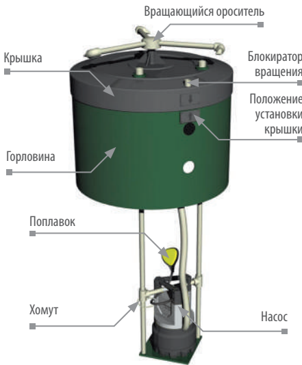
Рисунок 16. Установка циркуляционного насоса Станции.
